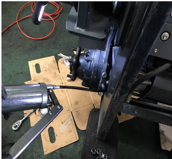
⑧ネジ締め後のWチェックとして黄色のマーカーをひき、タイヤ装着
